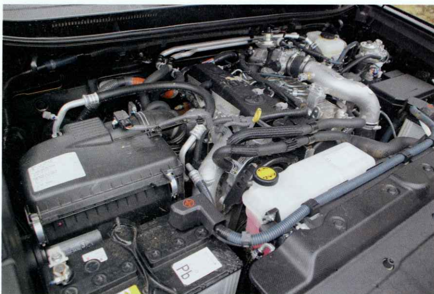
Arbeitstier: Beim 3,0-l-Aggregat kommt bei geringer Motorlast ein ventilgesteuerter ‚Exhaust Gas Recirculation‘ (EGR)-Kühlerbypass zum Einsatz. Er ist für die Regulierung der Temperatur in den Brennkammern zuständig und gewährleistet bei der Abgasrückführung einen möglichst geringen Abgasausstoß. Bild: Blenk
